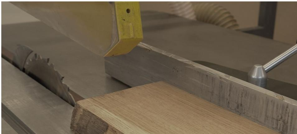
Parallelanschlag : Bei Durchschnit, Anschlagleiste soll um 45 ° zur Vorderkante des Sägeblatts verrückt sein
