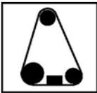
"CS" *Kombinierte Längskalibrier- und Längsschleif-Gruppe mit Walze und Schleifschuh.*
