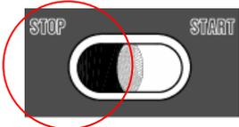
**TASTE STOPP BEARBEITUNG:** Stoppt den Werkstückvorschub und sämtliche Maschinenmotoren. Deaktiviert die Blasdüsen und das Aggregat zur Plattenreinigung. Taste drücken und Maschine stillsetzen.
