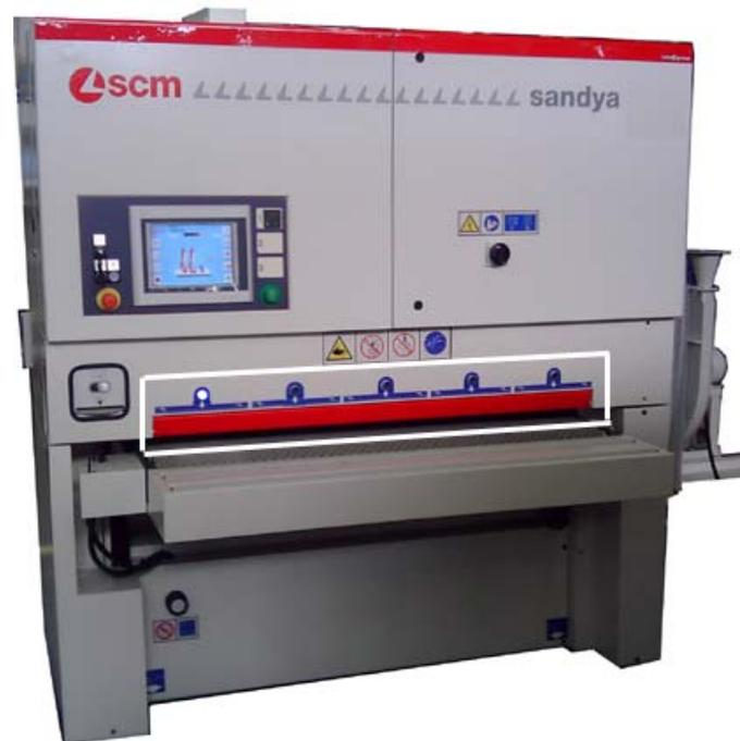
Jeder Leitlampe entspricht ein präziser Bereich des Schleifbands, wie in der nachstehenden Abbildung angegeben.
