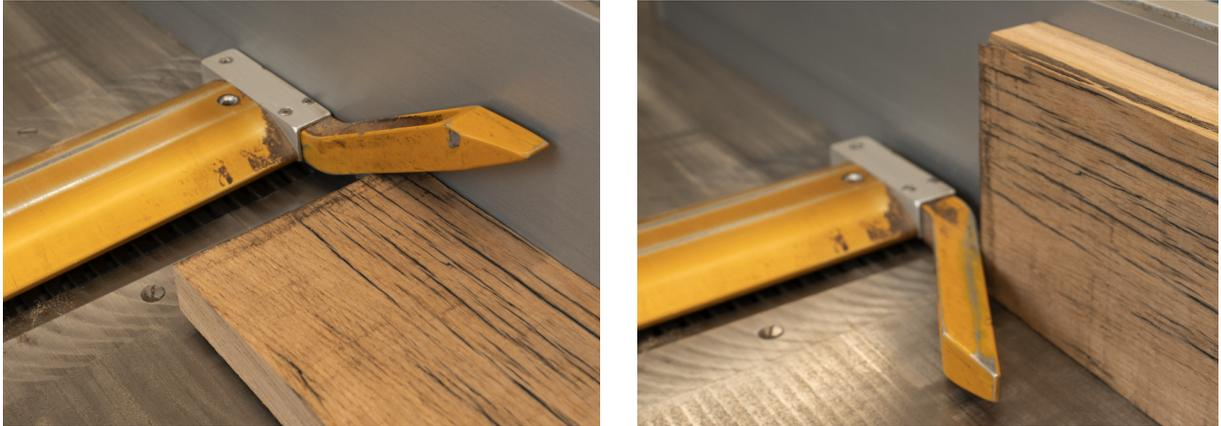
Abb. 2: links: Hebel Suvamatic nach oben um Fläche abzuhobeln,
